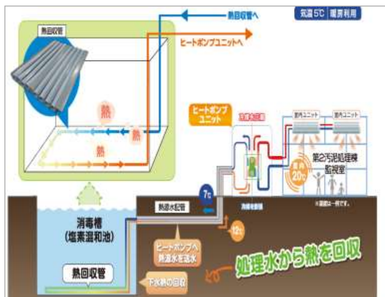
【下水熱を利用した空調システムのイメージ図】
