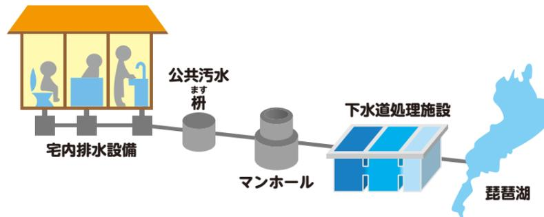
マンホールは、下水道管などと地上を結びように開けられた縦穴で、地下施設の点検・修理・清掃などをするためにあります。
