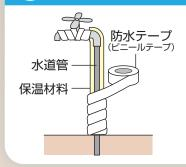
凍結する場所は、主に 屋外に露出している水 道管や蛇口です。そこ に布やフェルト(保温 材料)を巻き付け、濡 れないようにビニール テープでしっかりと巻 きます。
