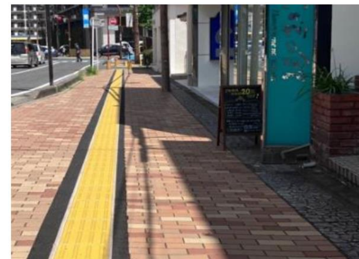
輝度比を確保した点字シートの設置例
