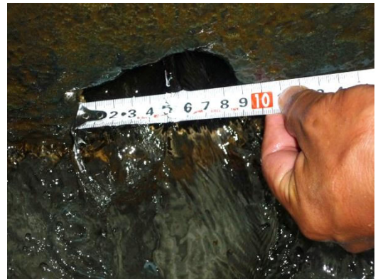
大津市御陵町水道管漏水箇所（約10cmの穴）
