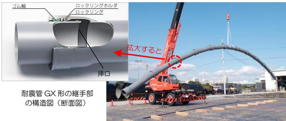
耐震管 GX 形の継手部の構造図（断面図）
