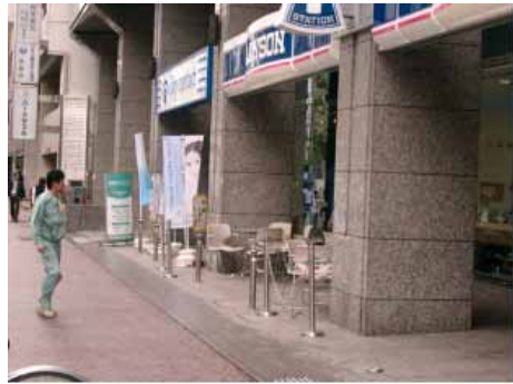
低層部をピロティとし、テーブルや椅子などを配置することで、建築物の圧迫感を緩和するとともにまち（商業地域）にぎわいを創出した例
