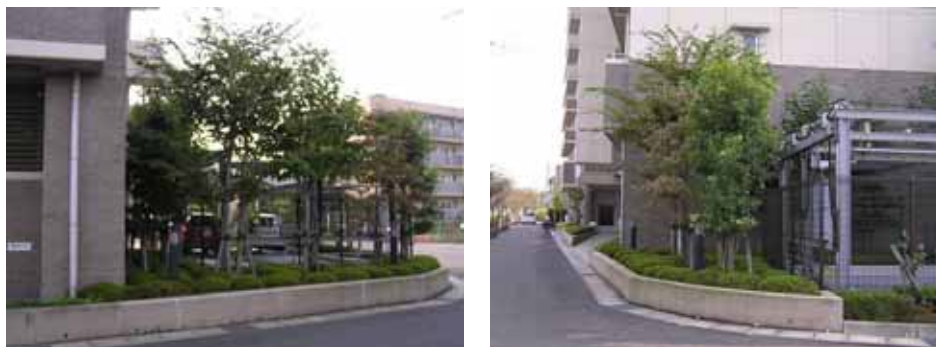
敷地境界線から後退し、植栽を行なうことで道路への威圧感、圧迫感を軽減した機械式駐車場の例
