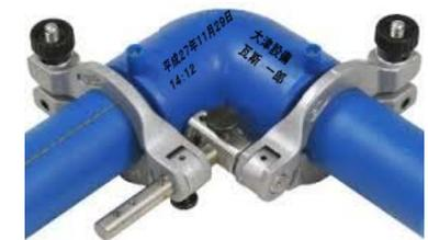
冷却時間:呼び径50以下5分、呼び径75以上10分
