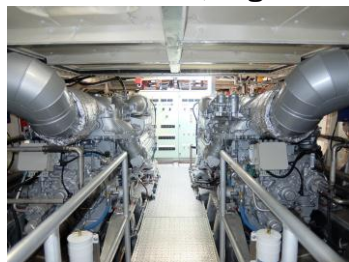
主機関(MTU製8V895kw:1217PS)×1基
