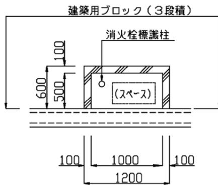
消火栓標識柱及び消火栓標識用地 標準図
