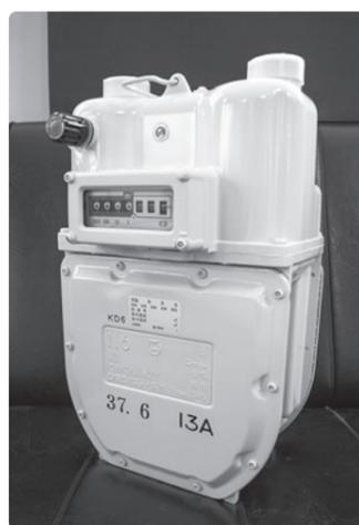
※マイコンメーターは、地震発生時に自動的に遮断され、復帰操作が必要です。復帰操作は、マイコンメーターの復帰ボタンのキャップをはずして、復旧ボタンを奥までしっかり押し、すぐ指を離してください。
