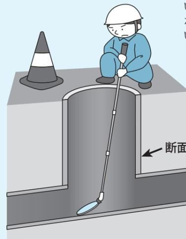
んな時に使用するのが、マンホール点検用鏡です。伸び縮みする棒の先に、角度調整ができる鏡が付いています。棒の長さや鏡の角度を変えることで、直接、見ることでできない管の様子を確認することができます。
