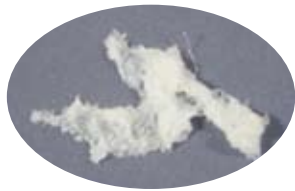
▲フレキシブル管内面の合成樹脂がはがれたもの
