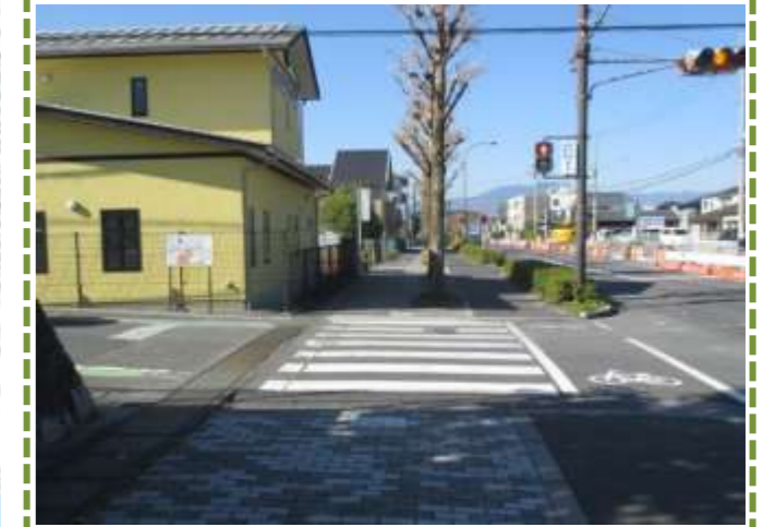
⑥歩道の中に街路樹帯が設置されている
