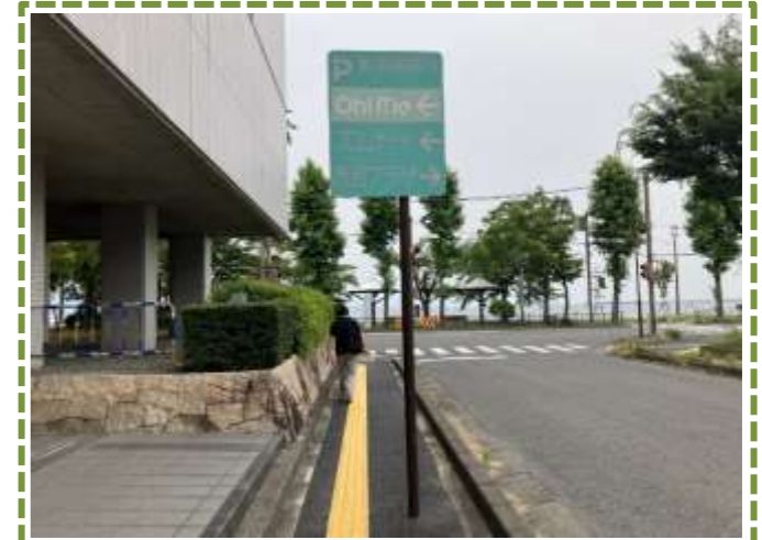
④案内看板が有効幅員を侵している
