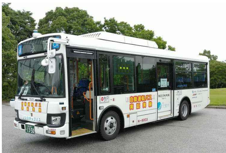
図 5.3 自動運転バスの実証実験（令和 2(2020) 年度）
