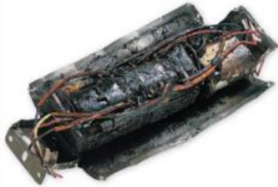
図8ー長期に使用された安定器を分解した例
