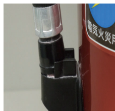
× 消火薬剤の漏れ
