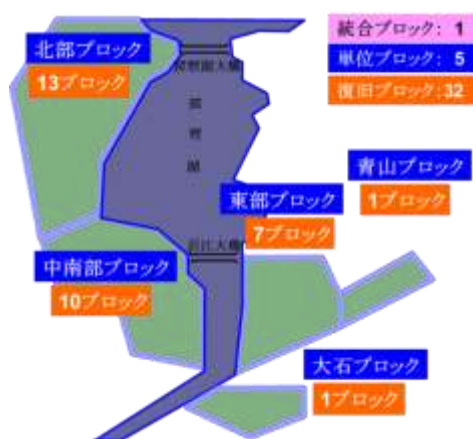
【ガス導管のブロック化】
