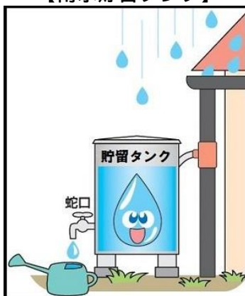
【雨水貯留タンク】
