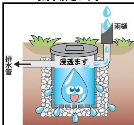
【雨水浸透ます】
