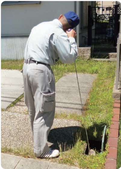
宅内の水道メーターなどに音聴棒をあて、漏水音の有無を調査します。
