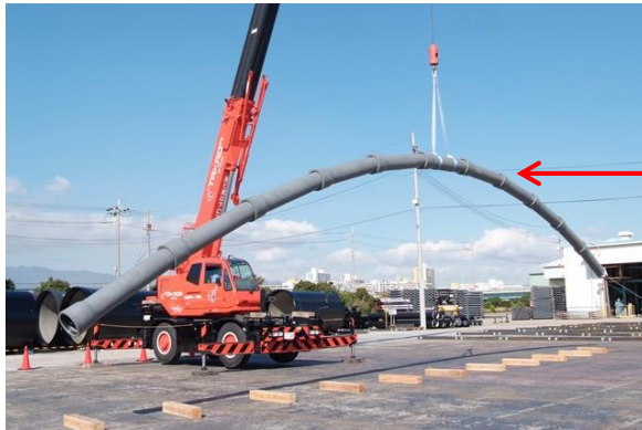
耐震管（ダクタイル鋳鉄管 GX 形） 出典）（一社）日本ダクタイル鉄管協会
