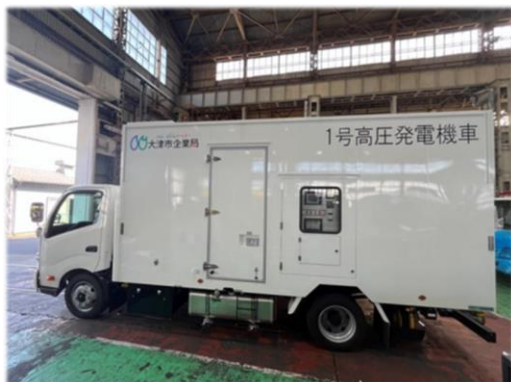
【高圧発電機車】
