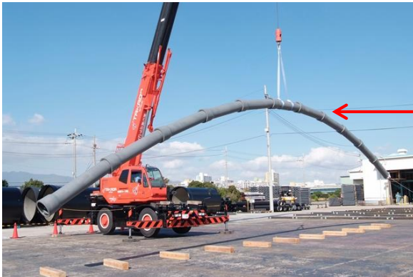
耐震管（ダクトイル鋳鉄管 GX 形） 出典）（一社）日本ダクトイル鉄管協会
