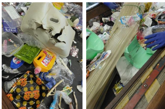
図9 破袋機通過後のプラスチック製品の状況
