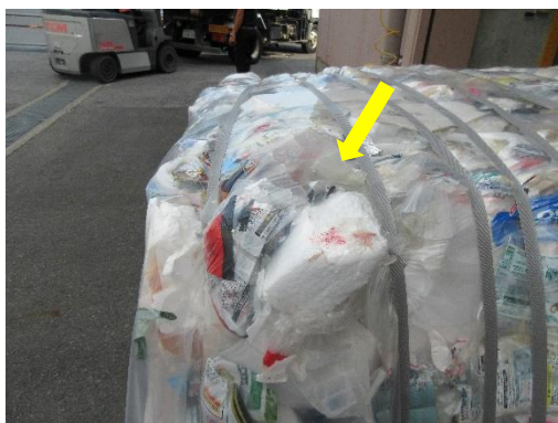
図7 条件1における成形品の外装袋破損の状況
