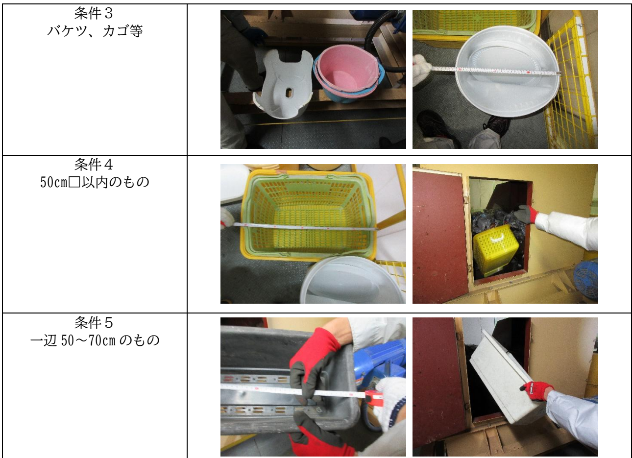
図 8 破袋機通過試験状況
